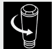
Filter uit het water-reservoir losdraaien
